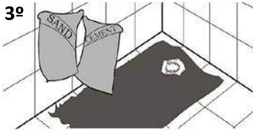
Macizar y nivelar con terrazo, dejando espacio suficiente para la fontanería y la válvula de desagüe. Esperar a que esté seca.
